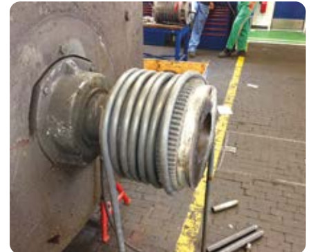
Erwärmung einer Kupplung zur Demontage
