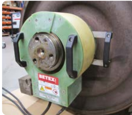
Erwärmung eines Lagerrings zur Demontage
