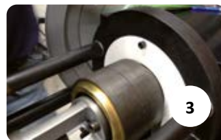
Schritt für Schritt Demontage von TBU / SP / TAROL Lagersätzen
