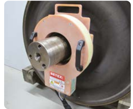
Erwärmung eines Labyrinthrings zur Demontage
